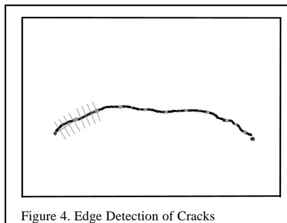
Figure 4. Edge Detection of Cracks
